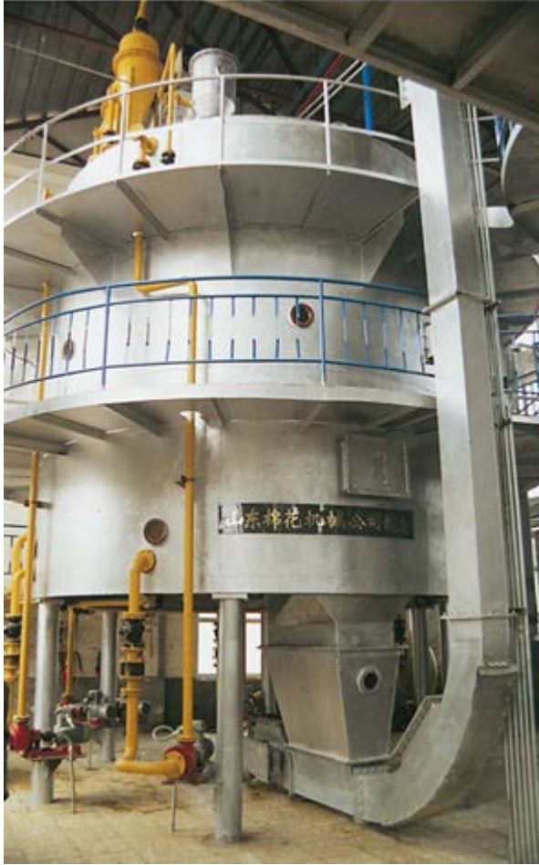
Şəkil 16. Pambıq toxumundan yağ çıxaran avadanlıq
