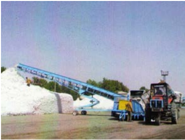
Şəkil 33. Pambığın konveyerlə tayalara vurulması
