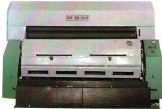
Şəkil 18. 5 ДП-130 markalı mışarlı cin
