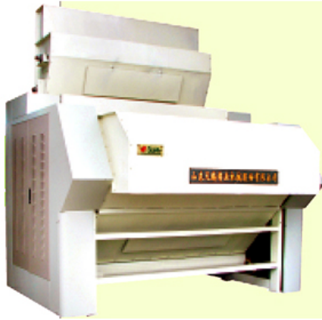
Şəkil 12. Tam yetişməmiş xam pambıq təmizləyən qurğu
