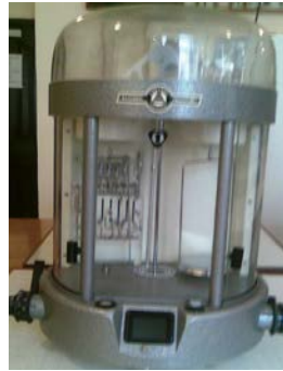
Şəkil 57. “WA” - 31 tipli analitik tərəzi
