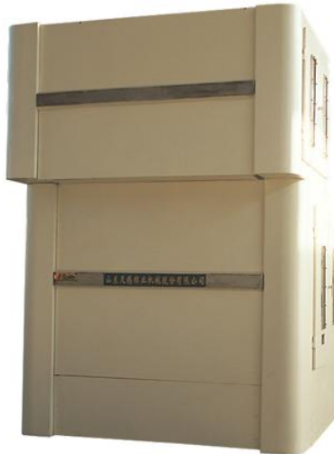
Şəkil 15. Xam pambığı xırda zir-zibildən təmizləyən qurğu
