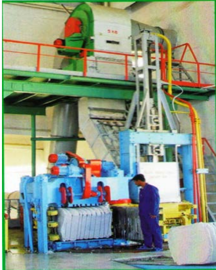
Şəkil 19. Pambıq mahlıcını kip şəklinə salınması
