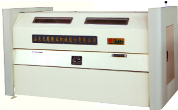
Şəkil 13. Pnevmatik (sıxılmış hava ilə işləyən) lif təmizləyən qurğu
